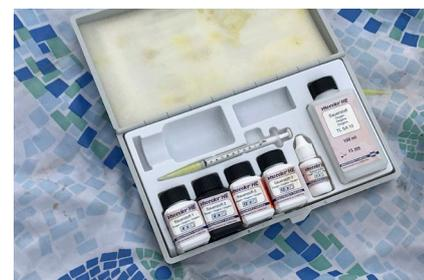
Figura 1: kit per il test dell'ossigeno in funzione. © Daria Göllnitz / GLOBE Svizzera
